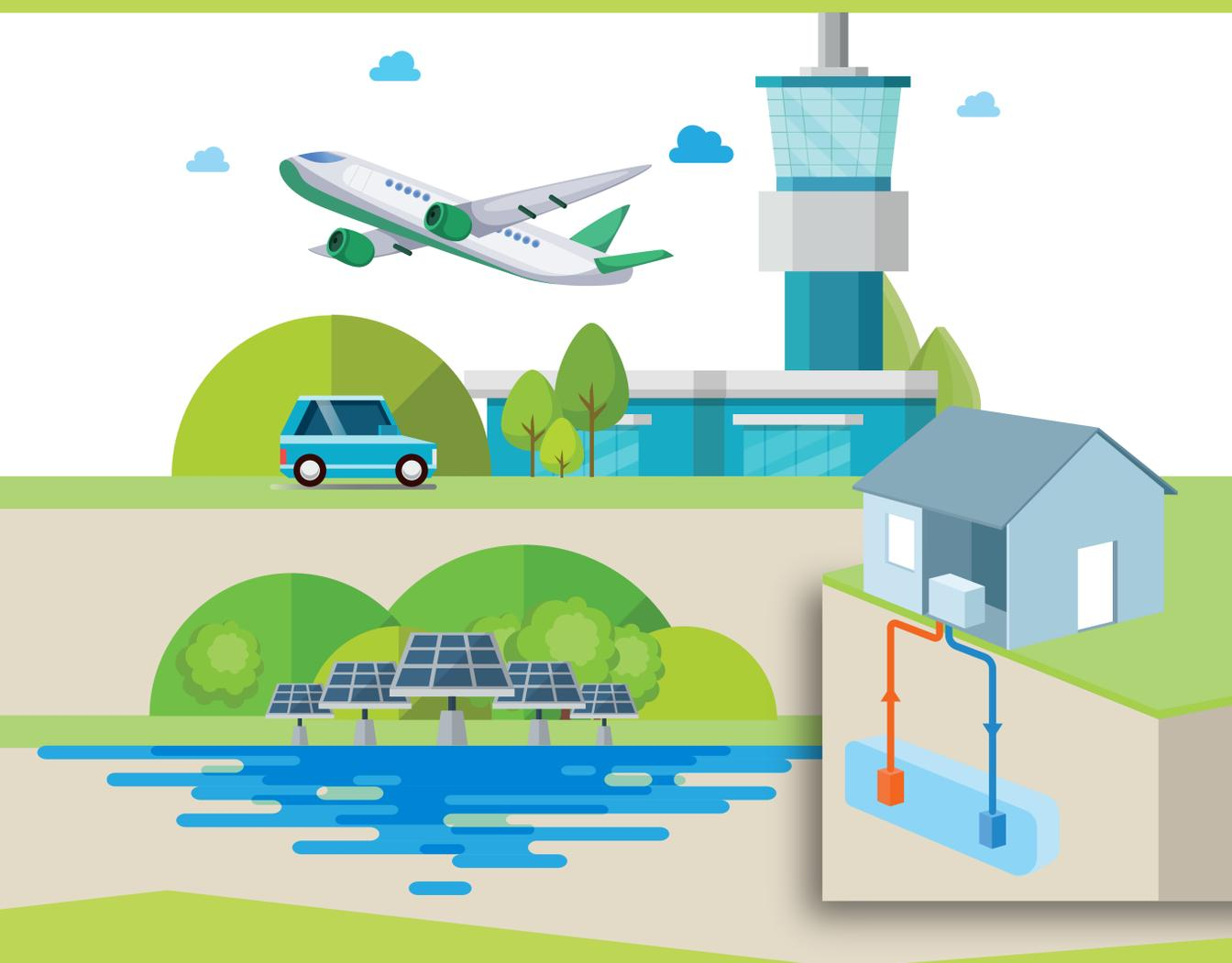
► La géothermie utilise la nappe pour chauffer en hiver et refroidir en été, de façon renouvelable et sans impact sur l'environnement, l'eau étant réinjectée sans perte. En complément, des pompes à chaleur réversibles assurent le relais si nécessaire.
